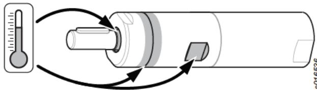
Les points chauds suivants sur le moteur (comme illustré sur la figure ci-dessus) peuvent atteindre des températures élevées en fonctionnement :
