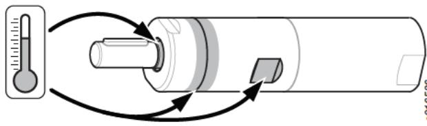
Järgmised kuumad punktid mootoril (nagu on näidatud eeltoodud joonisel) võivad jõuda töötamise ajal kõrgete temperatuurideeni.
