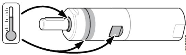
Šādi motora karstie punkti (kā redzams iepriekšējā attēlā) var sasniegāt augstas temperatūras ekspluatācijas laikā:
