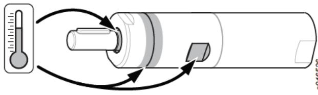
Los puntos calientes del motor, señalados en la figura anterior, pueden alcanzar temperaturas muy elevadas durante el funcionamiento:
