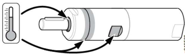
Următoarele puncte de pe motor pot atinge temperaturi ridicate în timpul funcționării (cum se arată în figura de mai sus):
