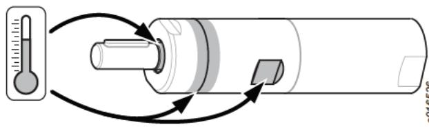
Sljedeće vruće točke na motoru (koje možete vidjeti na gornjoj slici) mogu doći visoke temperature za vrijeme rada:
