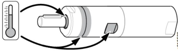
Följande markerade punkter på motorn (som visas på bilden ovan) kan bli mycket varma under drift:
