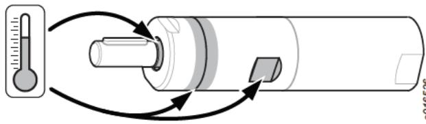
I seguenti punti caldi sul motore (come si vede nella figura in alto) possono raggiungere temperature elevate durante il funzionamento:
